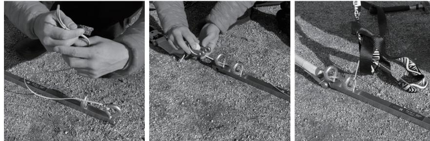
1. 杭にロープを接続します。 2. シャックルとロープを接続します。 3. シャックルから出ているスラックラインのテールとロープを接続します。
